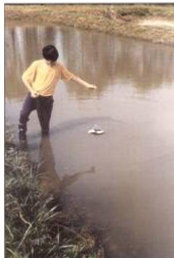
Figura 3: Registro de visibilidad con disco de Secchi
